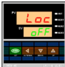
按 PAR 键 3 秒钟放开, 进入参数设定状态, 上显示窗 (PV) 显示第一个参数“Loc”符号, 下显示窗 (SV) 显示该参数当前的设定内容。可通过按“▲▼”键修改闪烁位的数值。
