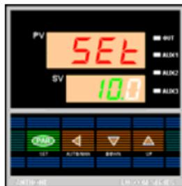
按一下 PAR 键立即放开, 进入给定值设定状态, 上显示窗 (PV) 显示“SEt”符号, 下显示窗 (SV) 出现闪烁数位, 可通过按“▲▼”键修改闪烁位的数值。
