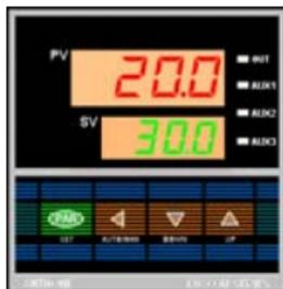
上显示窗 (PV) 显示测量值下显示窗 (SV) 显示给定值表示仪表正常的工作状态; 它根据测量值和设定值自动控制输出。
