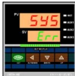
上显示窗显示“SYS”, 下显示窗显示“Err”表明仪表发生故障不能正常工作。
